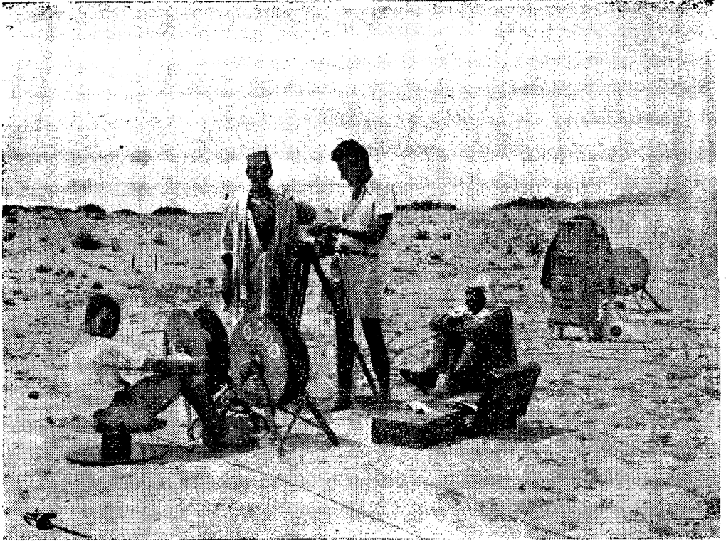
Planche I. — Méthode de prospection électrique par une équipe du Service Géologique (Photo Direction des Travaux Publics)
